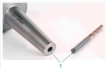
Abb. 8: Dehnspannfutter und Werkzeug reinigen
